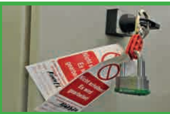
Multiblokada umożliwiająca założenie kilku kłódek.
