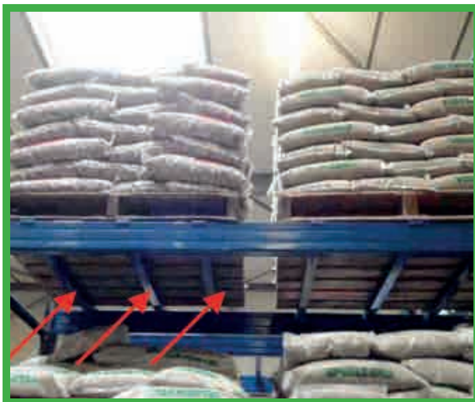
3 podpierające belki w regałach do składowania palet.
