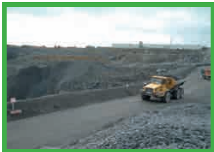
Praktyczny przykład obwałowania zabezpieczającego.
