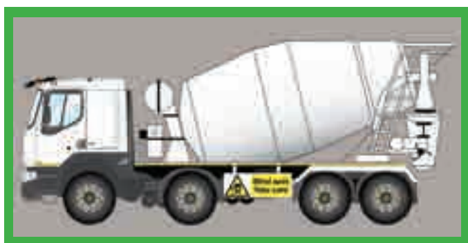
Boczne belki / osłony przeciwnajzdowe oraz ostrzegawcze oznakowanie dla pieszych i rowerzystów na nich montowane.
