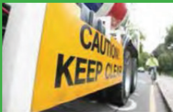
Boczne belki / osłony przeciwnajzdowe oraz ostrzegawcze oznakowanie dla pieszych i rowerzystów na nich montowane.
