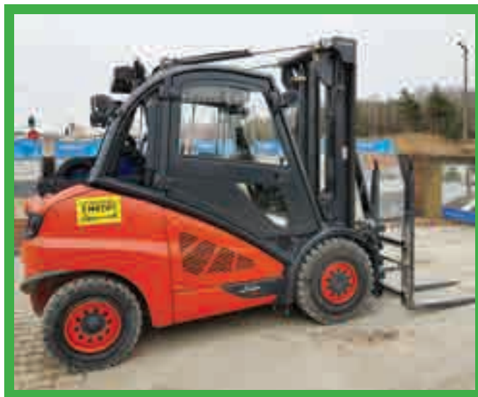
Zasada 2 metrów – wyraźna tablica ostrzegawcza umieszczona na pojeździe – „Nie zbliżać się do pojazdu na odległość mniejszą niż 2 metry”.
