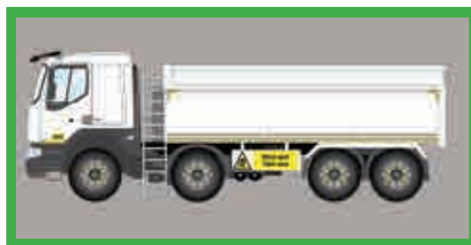
Boczne belki / osłony przeciwnajzdowe oraz ostrzegawcze oznakowanie dla pieszych i rowerzystów na nich montowane.
