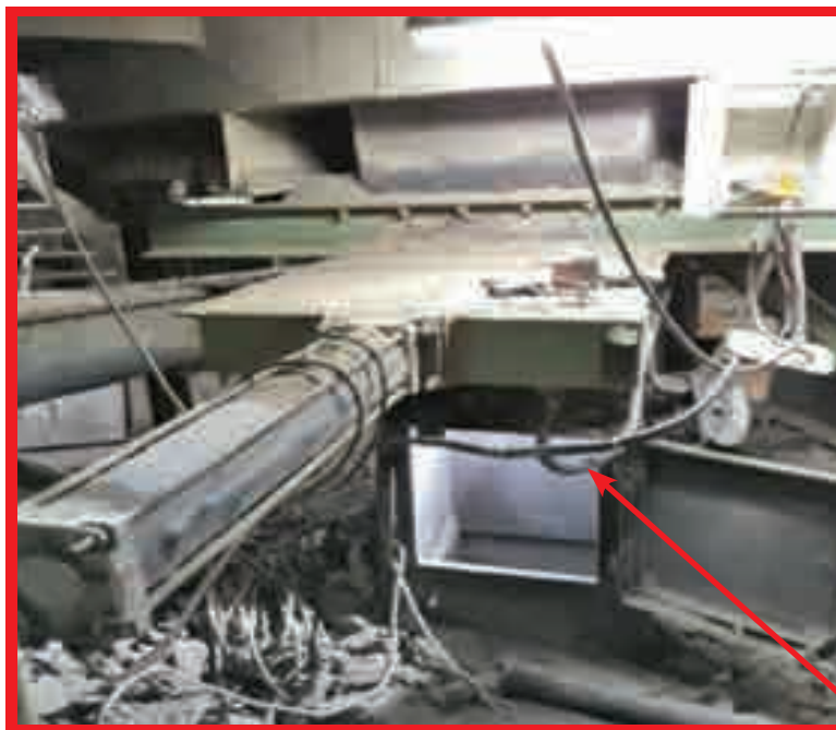
31 października 2017r.: Pracownik wykonawcy podczas czyszczenia wszedł do zesypu. W wyniku błędu zasuwa nad jego głową została otwarta co spowodowało jego zasypanie, a w konsekwencji śmierć pracownika.
