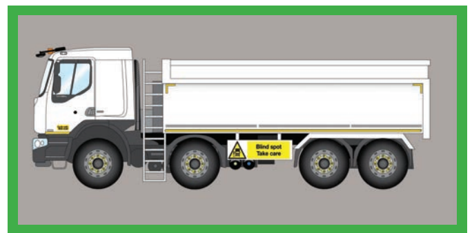
Boczne belki / osłony przeciwnajzdowe oraz ostrzegawcze oznakowanie dla pieszych i rowerzystów na nich montowane.
