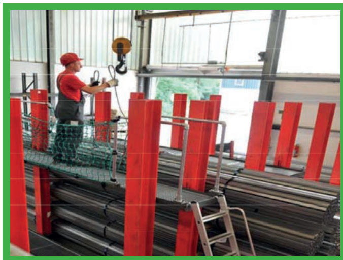
Bezpieczny dostęp do haka w celu podwieszenia na nim ładunku.
