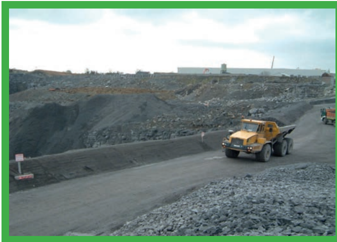
Praktyczny przykład obwałowania zabezpieczającego.
