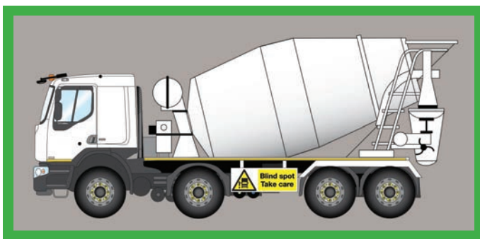
Boczne belki / osłony przeciwnajzdowe oraz ostrzegawcze oznakowanie dla pieszych i rowerzystów na nich montowane.
