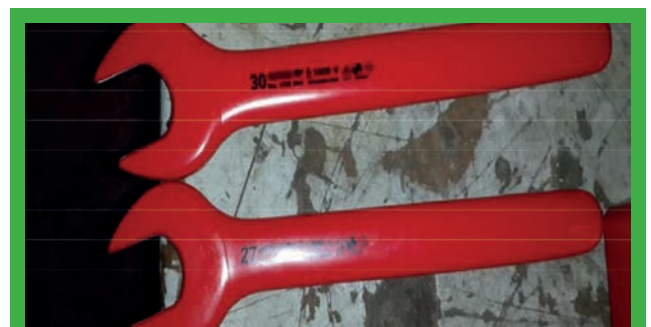
Instrukcje dla wszystkich użytkowników elektronarzędzi, aby używać tylko sprzętu z odpowiednim kolorem dla danego okresu (w systemie oznaczania kolorami).
