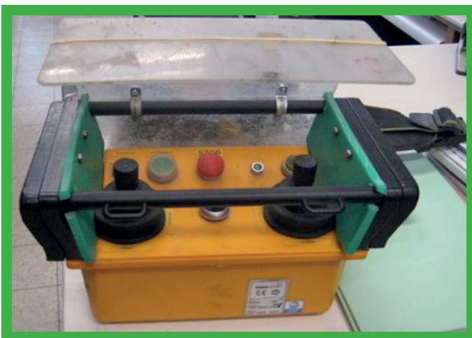
Kasety sterownicze z mechanizmem zabezpieczającym. W celu aktywacji "joysticka" należy go wcisnąć.
