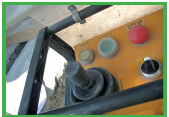
Kasety sterownicze z mechanizmem zabezpieczającym. W celu aktywacji "joysticka" należy go wcisnąć.
