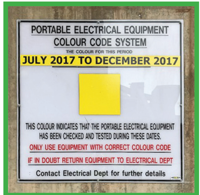
Instrukcje dla wszystkich użytkowników elektronarzędzi, aby używać tylko sprzętu z odpowiednim kolorem dla danego okresu (w systemie oznaczania kolorami).
